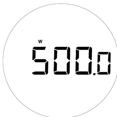
W という文字が小さくディスプレイ左上に出ている場合は、本体ははかりモードであることを示します。はかりモードでは、Orionをスマートスケールとしてお使いいただけます。これは産業用スケールと同様に機能します。はかりモードに切り替えるには電源ボタンを長押しし、[SCALE] が出るまでダイヤルを回したのち、電源ボタンを押して決定します。
