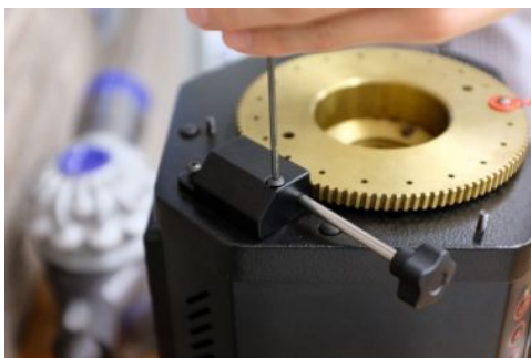
⑬ メッシュ調整バーを戻す 噛み合わせに気を付けて メッシュ調整バーを回して 上刃が動くか確認する
