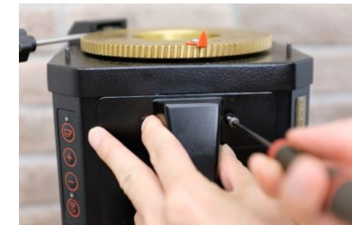
⑮ 粉排出口を戻し完了
