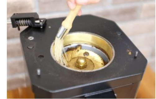
⑨ 下刃はグラインダーブラシなどを使って綺麗にする
